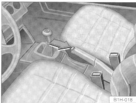
Para acionar o freio de estacionamento, puxe a alavanca firmemente. Em uma estrada íngreme, engate adicionalmente a 1ª velocidade ou, com caixa de velocidades automática, o bloqueio de estacionamento. A alavanca do freio de estacionamento deve ser puxada firmemente para evitar que o carro circule, por inadvertência, com o freio acionado.
