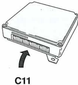
Das Signal an Pin C11 geht bei manueller Klimaanlage vom Schalter E 30 für Klimaanlage und bei digitaler Klimaanlage von der Bedien- und Anzeigeeinheit E 87 ein.
