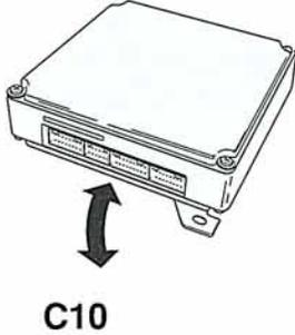
Das Signal an Pin C10 ist bidirektional. Das heißt, es kann als Eingangssignal vom Steuergerät J 153 für die Magnetkupplung zum MPI-Steuergerät oder als Ausgangssignal in umgekehrter Richtung vorliegen.
