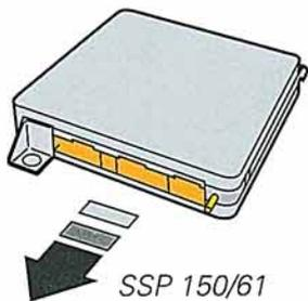
Das Signal vom Drosselklappenpotentiometer wird vom MPFI-Steuergerät digitalisiert und an das Steuergerät des Automatikgetriebes gesendet.
