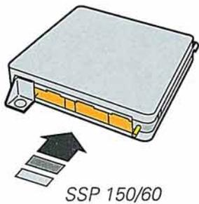
Über den Pin B 3 legt das MPFI-Steuergerät eine Signalspannung an den entsprechenden Pin des Automatikgetriebe-Steuergerätes.
