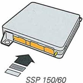
Das Klimaanlage-Signal wird bei elektronisch geregelter Klimaanlage von der Bedien- und Anzeigeeinheit E 87 geliefert.
