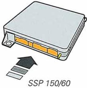
Das digitale Fahrgeschwindigkeitssignal erhält das MPFI-Steuergerät vom Fahrgeschwindigkeitsmesser G 21.
