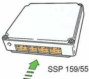
Das Digitale Fahrgeschwindigkeits-Signal erhält das MPI-Steuergerät vom Geschwindigkeitsmesser (G21).
