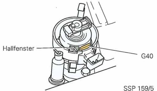
Die Blende des Zündverteilers besitzt nur noch **ein "Hallfenster"**. Decken sich Hallgeber-Signal und Zündzeitpunkt-Signal vom Geber für Motordrehzahl, erkennt das MPI-Steuergerät die Zünd-OT-Stellung des 1. Zylinders.
