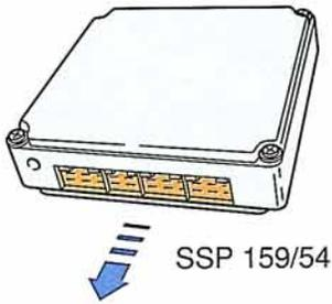
Das Drosselklappen-Signal wird vom MPI-Steuergerät digitalisiert und an das Steuergerät für autom. Getriebe gesendet.
