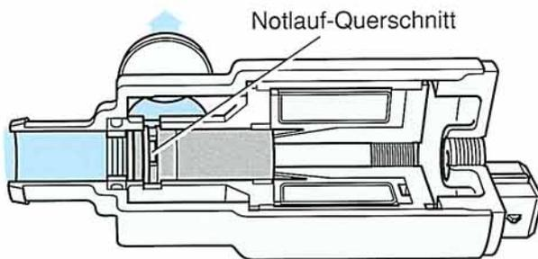
Erfolgt keine Ansteuerung durch das MPI-Steuergerät, befindet sich der Hubkolben in seiner Endstellung. In diesem Fall dient der Notlauf-Querschnitt im Hubkolben als Luftbypass.
