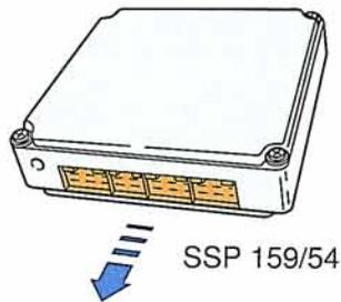
Das digitale Drehzahl-Signal bildet das MPI-Steuergerät aus dem Drehzahl-Signal vom Geber für Motordrehzahl (G28).
