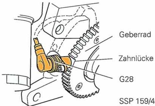
Der Geber für Motordrehzahl erfasst die winkelgenaue Stellung der Kurbelwelle und die Motordrehzahl am Geberrad der Kurbelwelle. Die Zahnlücke auf dem Geberrad dient als Bezugsmarke (Zündzeitpunkt-Signal).
