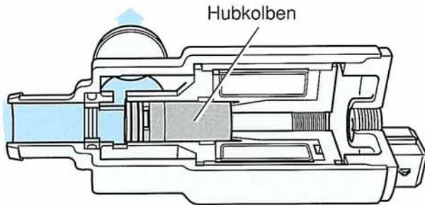
Entsprechend der Ansteuerung des MPI-Steuergerätes regelt der Hubkolben im N71 den Öffnungsquerschnitt des variablen Luftbypasses.
