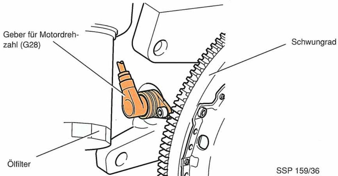
Er erfaßt die winkelgenaue Stellung der Kurbelwelle (Festlegung des Zünd- und Einspritzzeitpunktes) und die Motordrehzahl.
