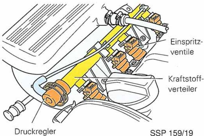
Im Kraftstoffverteiler sind Druckregler und Einspritzventile eingebaut.
