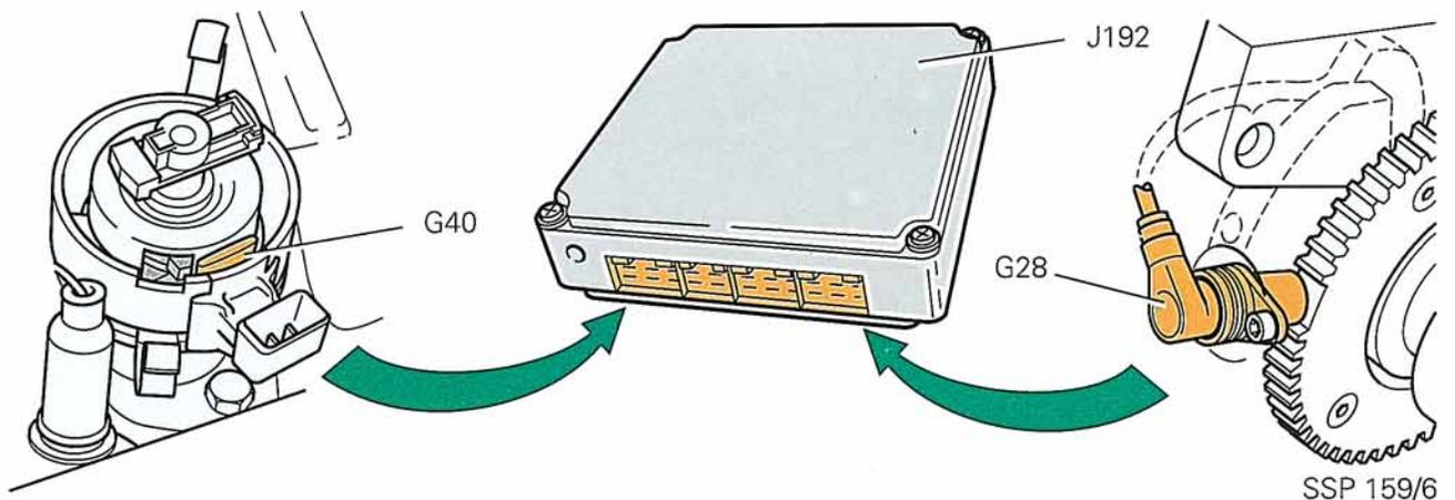
Durch die eingehenden Signale vom Geber für Motordrehzahl und Hallgeber erkennt das MPI-Steuergerät die Motordrehzahl sowie die winkelgenaue Kurbelwellenstellung des 1. Zylinders und kann so die sequentielle Einspritzung und zylinderselektive Klopfregelung steuern.
