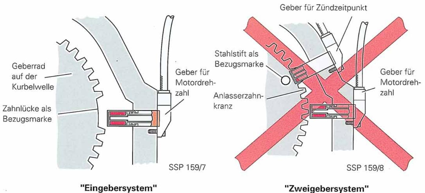
Die MPI Einspritz- und Zündanlage arbeitet mit dem "Eingebersystem". Anders als beim "Zweigebersystem" werden Motordrehzahl- und Zündzeitpunkt-Signal beim Eingebersystem nur noch vom Geber für Motordrehzahl erfaßt.
