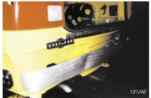
Beim Passat '97 kann der Stoßfänger bei einem Heck-Crash mit niedriger Fahrgeschwindigkeit soviel Energie aufnehmen, daß nur Kunststoffteile ersetzt werden müssen. Zeitraubende Schweißarbeiten entfallen.
