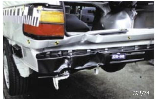
Früher waren auch schon bei Bagatell-Unfällen aufwendige Reparatur- und Schweißarbeiten notwendig, um die Beschädigungen an den hinteren Stoßfängern zu beheben.
