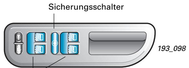
Durch die Taster am Bedienfeld der Fahrertür können alle Fensterheber vom Fahrer angesteuert werden.
