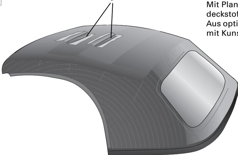
Die Webrichtung und Spannung des Verdeckstoffes sind so ausgelegt, daß die Luftströmung möglichst lange anliegt.
