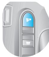
Bedienungs- und Anzeigeeinheit für Klimaanlage (kein automatischer Betrieb)
