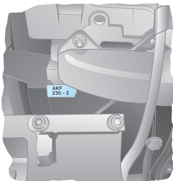
Motorkennbuchstabe und Motornummer befinden sich am Zylinder 5 unterhalb der Abgaskrümmerebefestigung.
