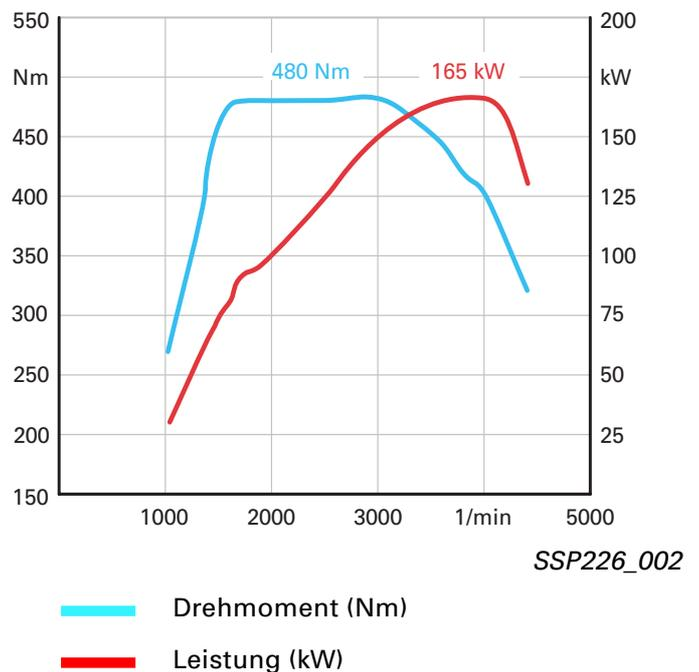
Das max. Drehmoment von 480 Nm wird schon bei 1800 1/min erreicht und bleibt bis 3000 1/min konstant auf diesem hohen Niveau.
