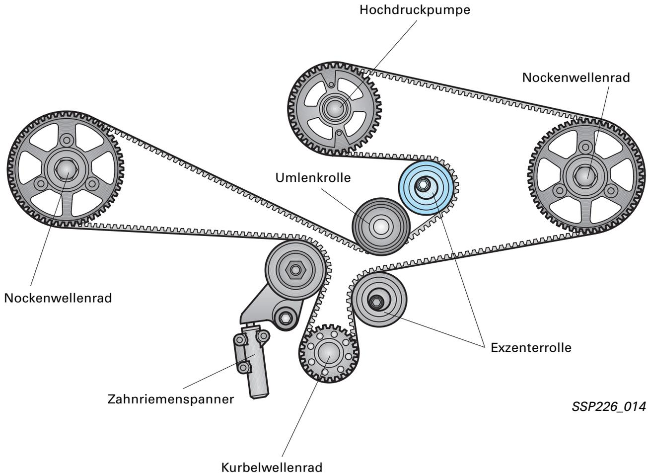
Der Antrieb der Hochdruckpumpe für das Common-Rail-System ist im Zahnriementrieb integriert.
