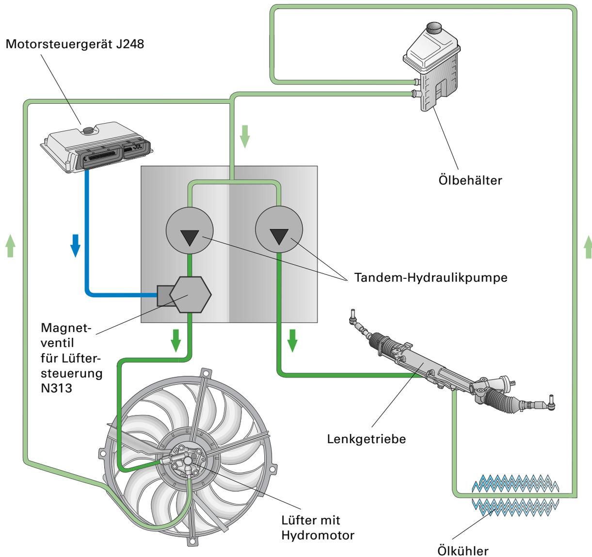
Mit der Tandem-Hydraulikpumpe, angetrieben vom Keilrippenriemen, werden gleichzeitig die Servolenkung und der hydraulische Lüfter mit Öldruck versorgt.
