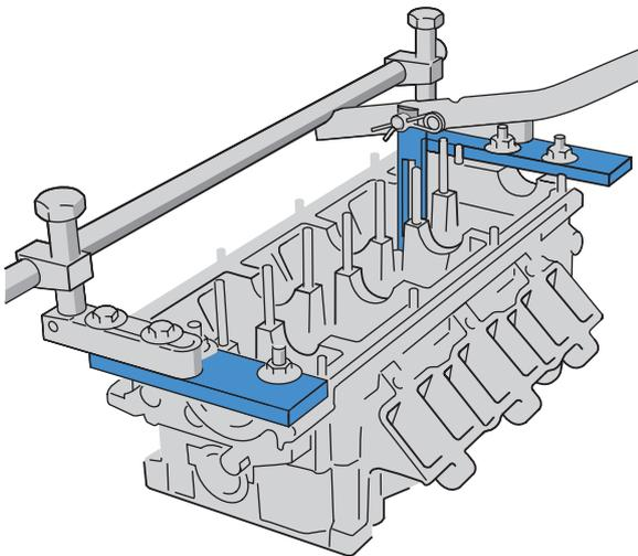
Spezialwerkzeug zum Ventilausbau
