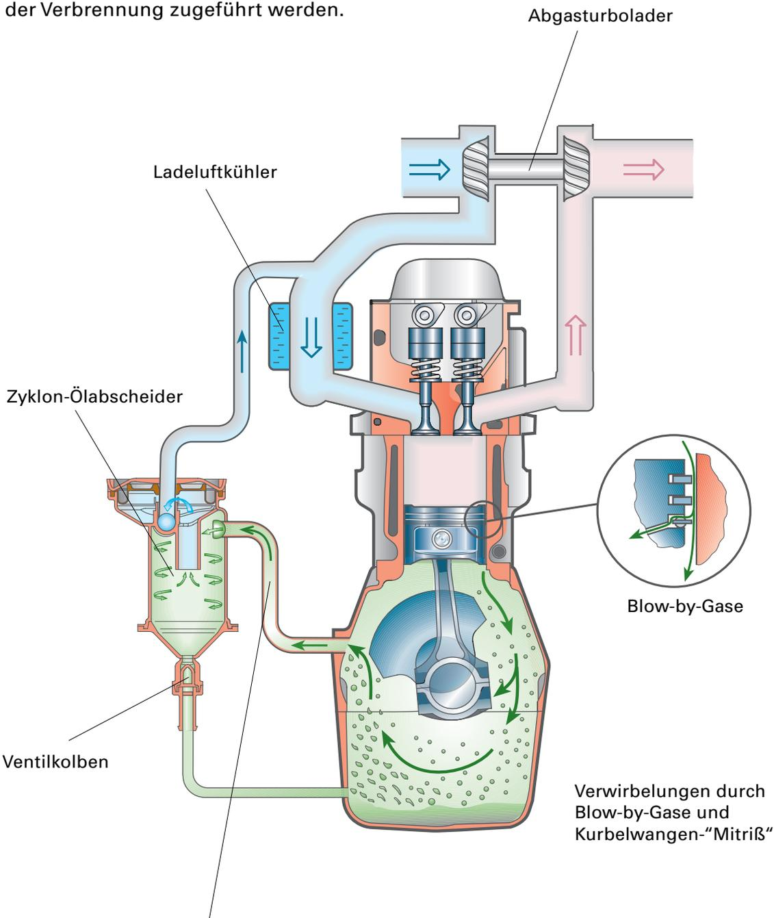
Der vom Kurbelgehäuse abgesaugte Ölnebel setzt sich schon in der Entlüftungsleitung teilweise tröpfchenförmig ab und fließt in das Kurbelgehäuse zurück.
