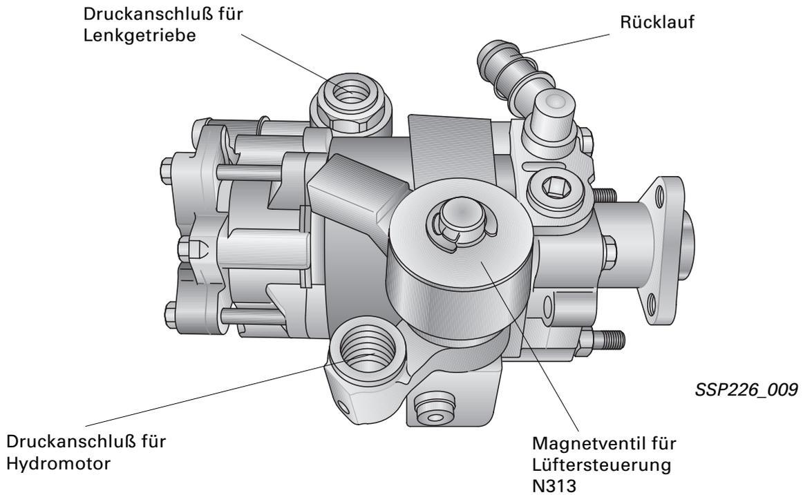
Das Innenzahnrad, welches direkt mit dem Lüfterrad verbunden ist, wird durch die geregelte Ölmenge angetrieben. Der Ölstrom gelangt über die Rücklaufleitung in die Saugleitung der Tandemhydraulikpumpe für die Servolenkung.
