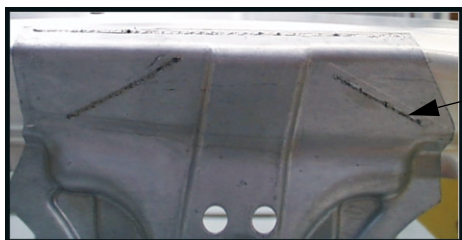
Dachrahmen seitlich Strangpressprofil
