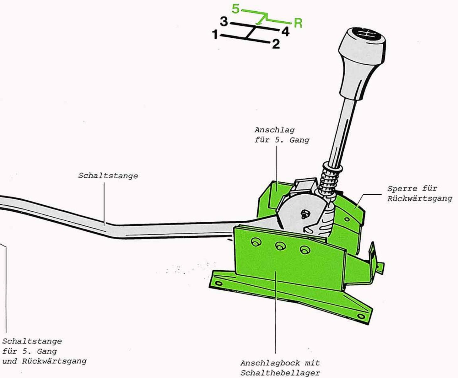
Die Einstellung der Schaltung erfolgt mit der Lehre 3048 an der Klemmschelle der Schaltstange.
