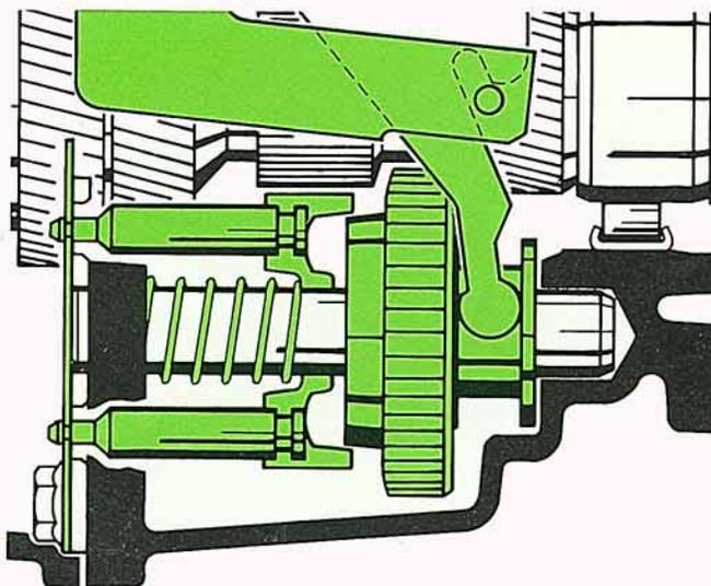
Der Synchronring ist auf der Achse des Schaltrades für den Rückwärtsgang gelagert.
