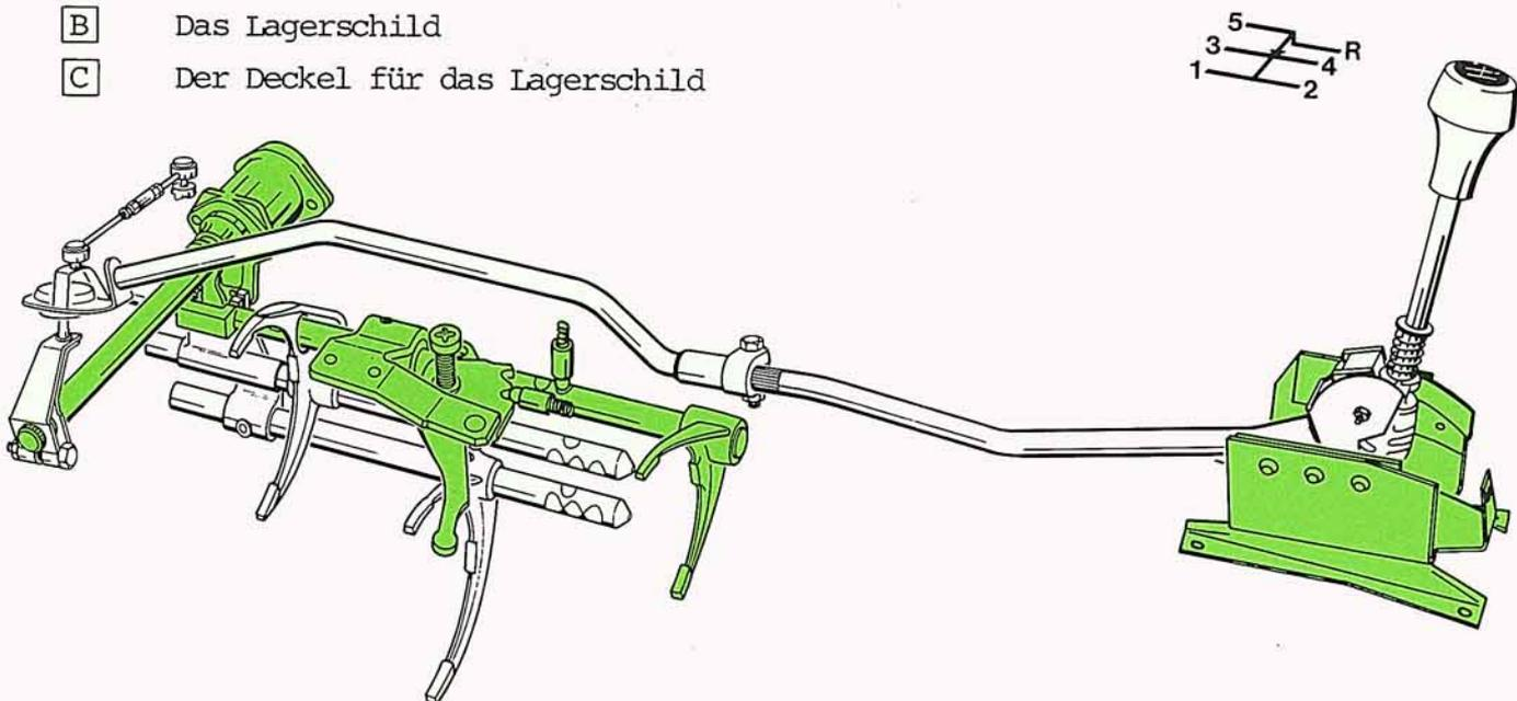
Der Anschlagbock und das Schalthebellager sind verbreitert worden. Die Sperre für den 5. Gang und die Seitendruckfeder sind in das Gehäuse der Schaltwelle eingebaut.
