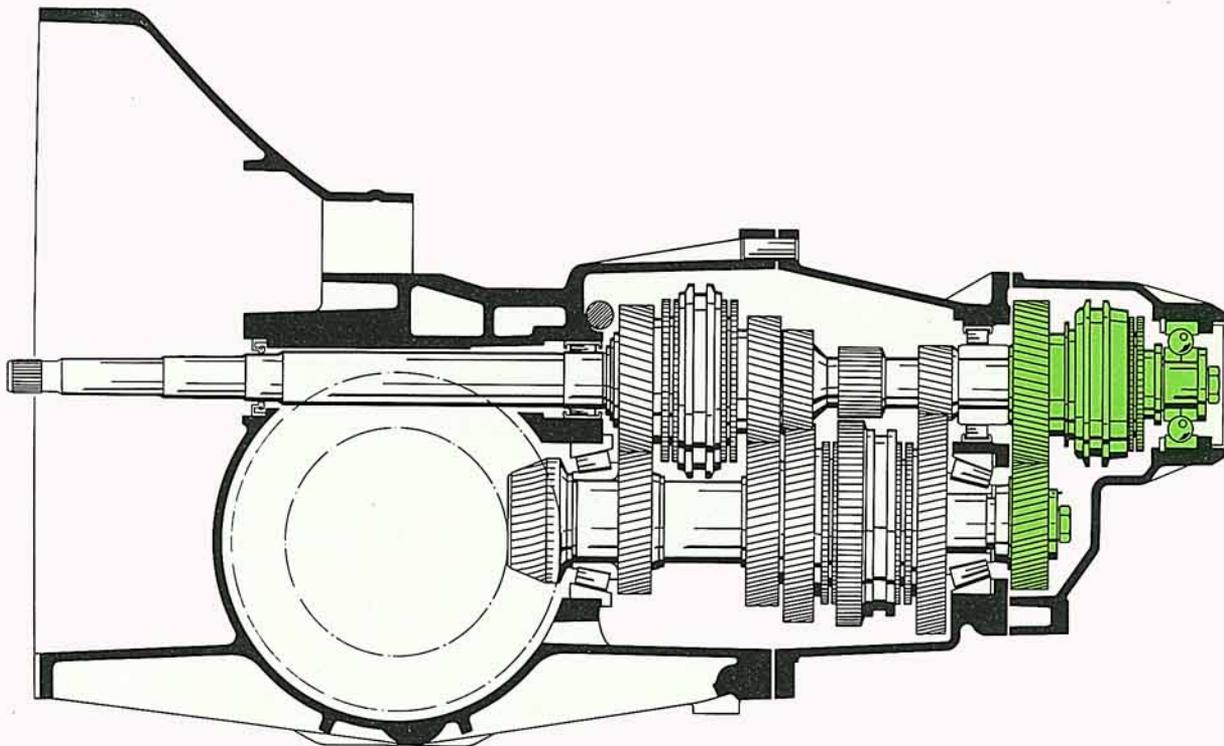
Der 5. Gang ist mit der Synchronisation vor dem Lagerschild angeordnet. Die Antriebswelle ist zusätzlich mit einem Kugellager im Deckel gelagert.
