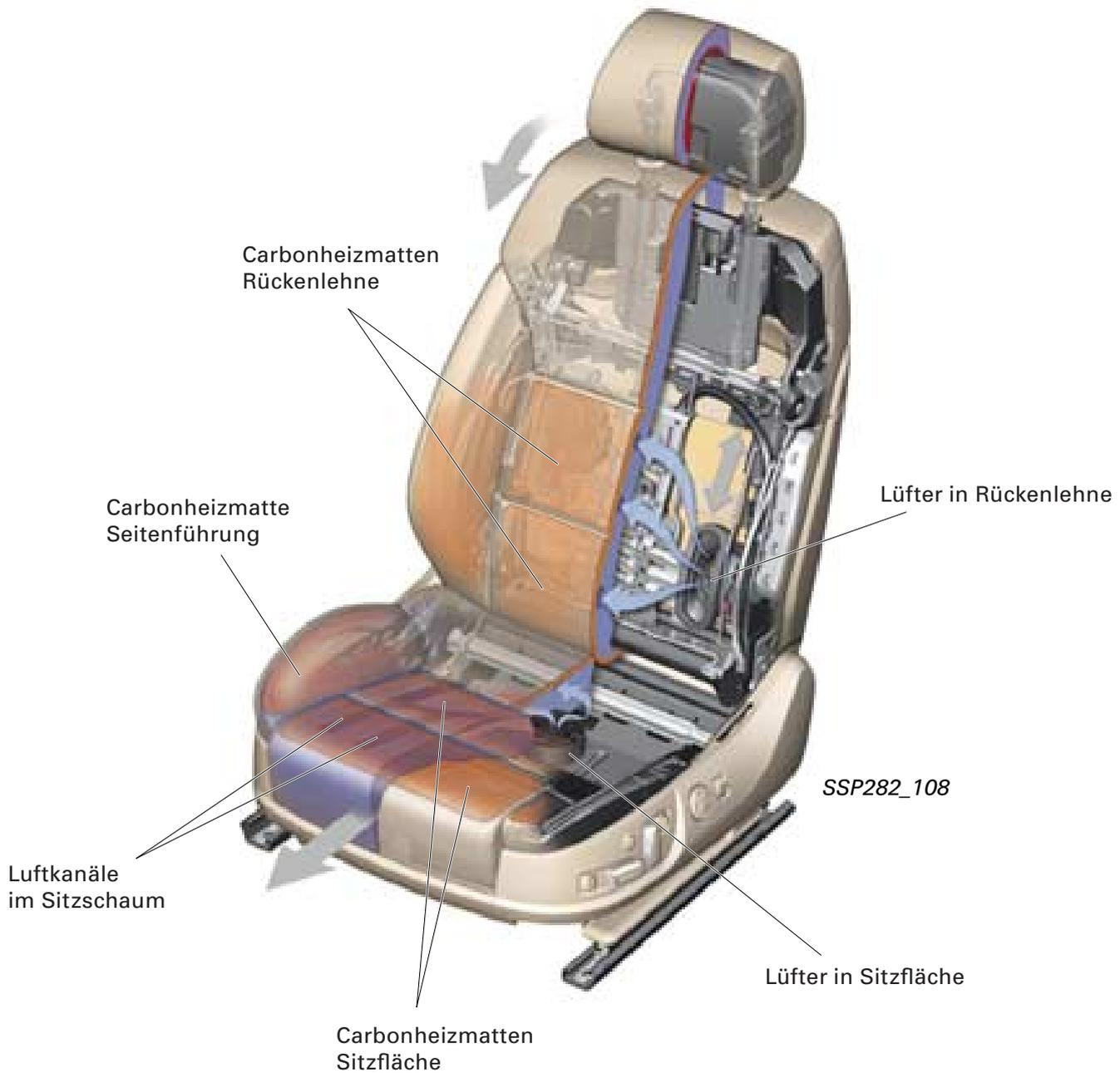
Die Klimatisierung der Sitze wird durch integrierte Lüfter in Sitzfläche und Rückenlehne erreicht. Über Luftkanäle im Sitzschaum wird die von der Sitzheizung temperierte Luft durch die feine Perforierung des Leders zum Insassen geleitet.
