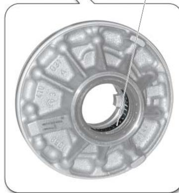
Die Lagerung des Drehmomentwandlers im Ölpumpengehäuse ist mittels eines verschleißfesten Rollenlagers ausgeführt. Diese Konstruktion sorgt für eine hohe Haltbarkeit der Lagerung, besonders bei Betriebszuständen mit geringer Ölzufuhr (bei Kaltneustart).
