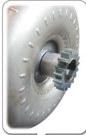
Bei der Montage des Drehmomentwandlers ist besonders darauf zu achten, dass die Nuten der Wandlernabe in die Mitnehmer der Ölpumpe greifen. Siehe Reparaturleitfaden.
