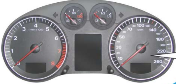
J285 - Steuergerät mit Anzeigeeinheit im Schalttafeleinsatz
