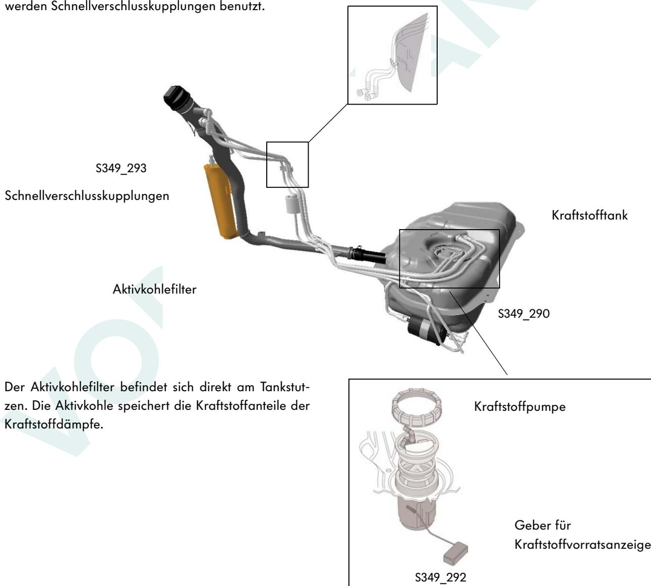
Der Aktivkohlefilter befindet sich direkt am Tankstutzen. Die Aktivkohle speichert die Kraftstoffanteile der Kraftstoffdämpfe.
