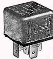
Über das Schrittelais für ABS wird das System über Klemme 50 oder von Hand mit dem ABS-Schalter eingeschaltet. Das Relais sitzt links unter der Schalttafel auf der Steckleiste.
