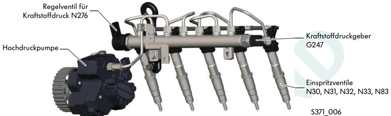
Alle 2,5l-TDI-Motoren im CRAFTER sind mit einem Common-Rail-Einspritzsystem für die Gemischaufbereitung ausgestattet.
